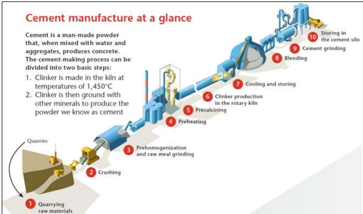
Figura B.2 – As principais fases do processo de produção do cimento
